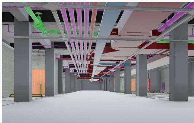
项目从钢构件生产加工就开始应用 BIM 技术，通过 BIM 深化，解决了项目各专业碰撞、管线综合布置、建筑净高控制等难题，并能实时掌握现场施工状况，提高了管理效率。
