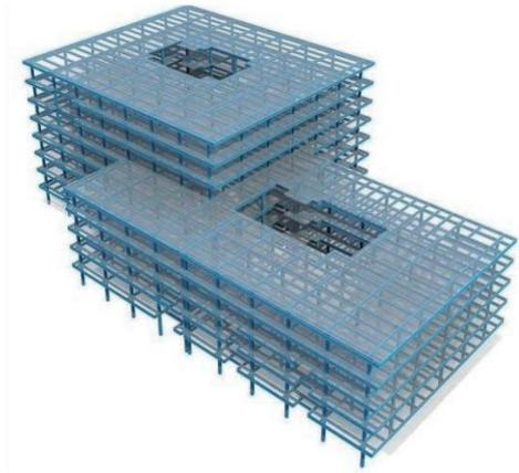
A4 图书馆，钢筋混凝土框架结构，屋顶为钢结构采光顶，最大跨度约 20m。顶标高为 23.69m。采光顶钢结构有弯弧箱型钢梁，材质为 Q355B。（如下图）
