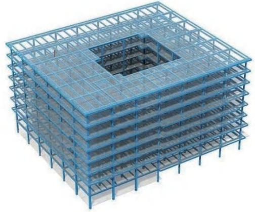
A10 科研楼，为钢框架结构。地上 8 层，建筑高度 29.9m。钢结构内容包括框架柱、框架梁等。材质均为 Q355B。（如下图）
